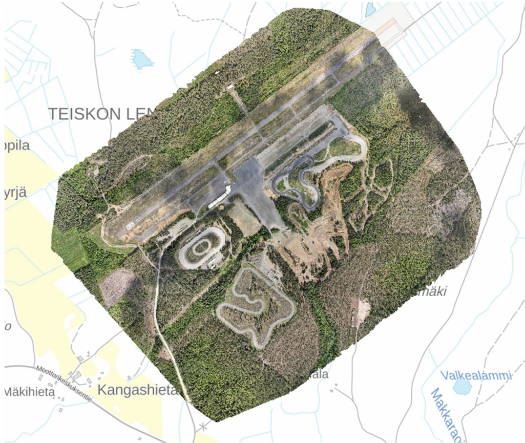
Kuva 6. Teiskon alueelta luotu tarkka ortokuva, joka voidaan esittää tilannekuvajärjestelmän karttapohjana. Kuvattu alue oli kuitenkin muuttunut asematason maarakennustöiden johdosta, joten kokeilussa muutosalue kuvattiin ja alueesta laskettiin uusi ortokuva.
