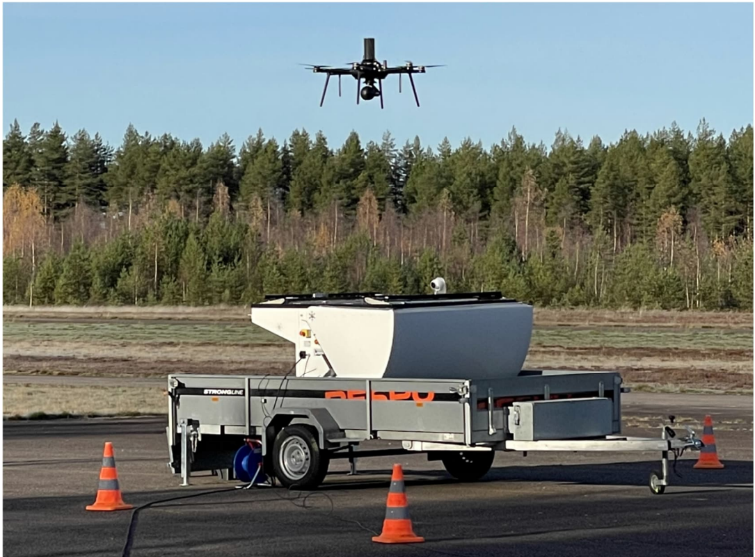
Kuva 1. NDN-ilma-alusjärjestelmä laskeutumassa telakointiasemaansa. Kuva Petri Koskinen, Business Tampere.
