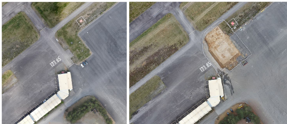
Kuva 7. Teiskon lentopaikan asematason ortokuva ennen ja jälkeen maarakennustöiden aloittamista. Tuore laskettu ”paikkokuva” voidaan esittää aiemmin kuvatun ortokuvan päällä.
