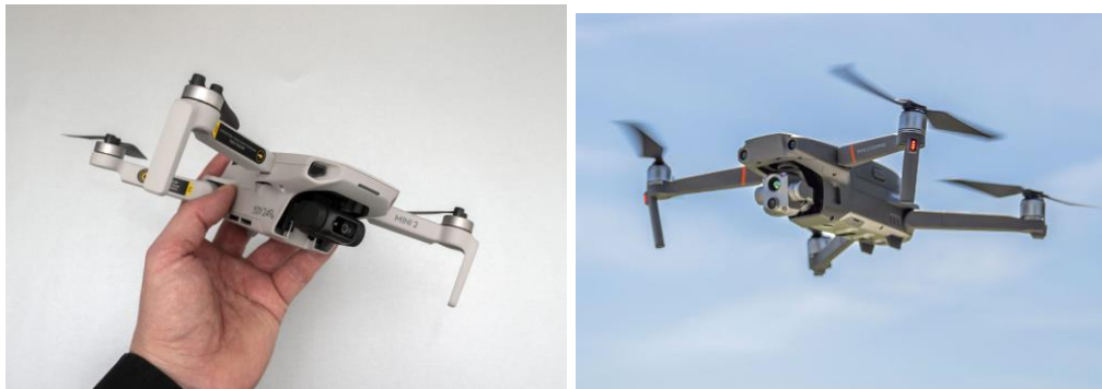
Kuva 1. Kokeilussa käytetyt miehittämättömät ilma-alukset DJI Mini 2 (vasen) ja DJI Mavic 2 Enterprise Advanced (oikea)
