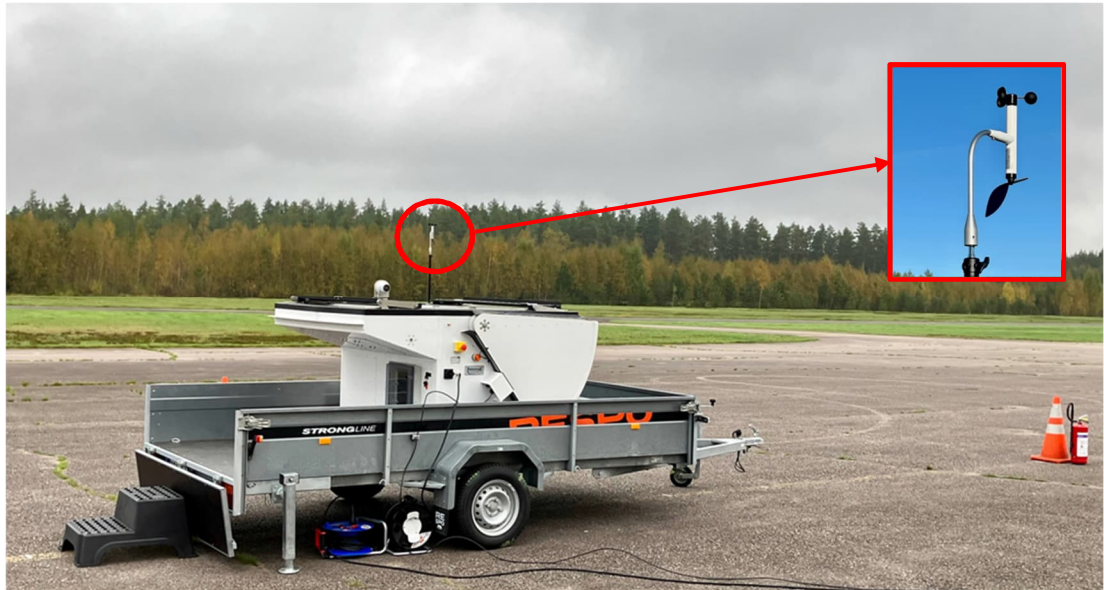
Kuva 7. Nokian NDN-ilma-alusjärjestelmän perävaunuun sijoitettu telakointiasema, joka varustettu valvontakameralla ja erillisellä sääasemalla.
